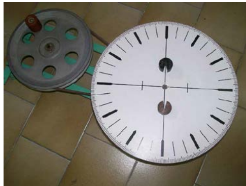
FIGURA 3 DISPOSITIVO EMPLEADO EN LA EXPERIENCIA 2. LOS CUERPOS SE POSICIONAN A LA MISMA DISTANCIA DEL CENTRO DE LA PLATAFORMA.
